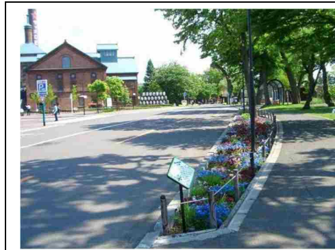
道路や駐車場からの雨水を在来種植栽を施した花壇に誘導し一時的に貯留してから地中へ浸透させる事例（雨水浸透型花壇／札幌市） 出典 6
