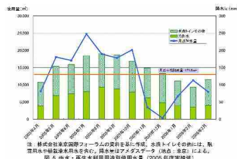
大規模コンベンションセンターにおいてトイレ洗浄水、屋上融雪、植栽灌水、冷却水、防災用上水の交換水と雨水利用の複合を行っている事例（東京国際フォーラム事例） 出典2
