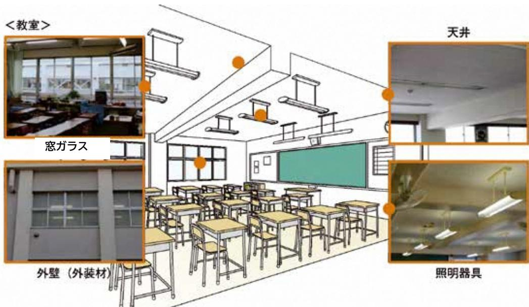
図 8-4 非構造部材の一例
