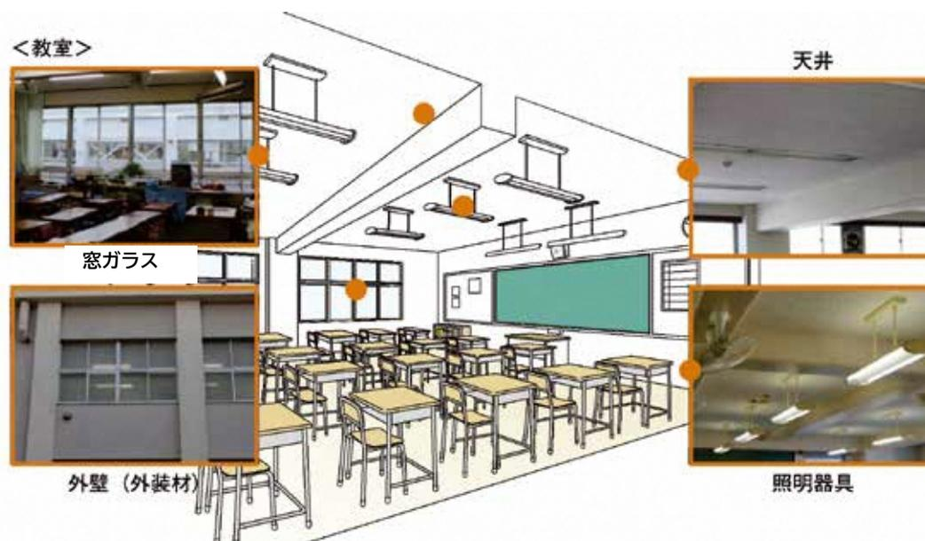
図 8-4 非構造部材の一例
