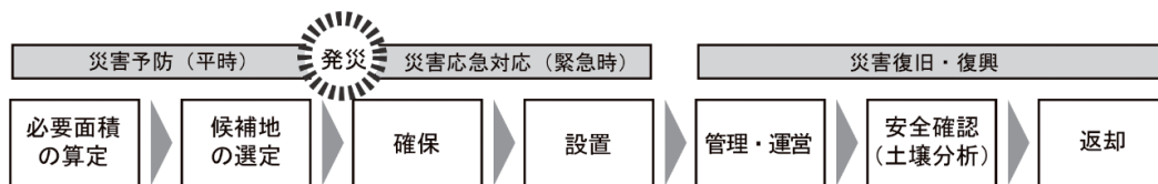
図2-7 仮置場の検討フロー（例）
