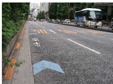
車道混在 (自転車ナビマーク・ナビライン) 鍛冶橋通り(中央区)
