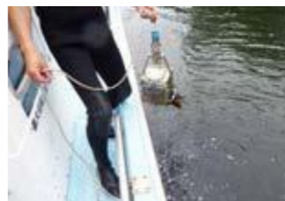
川の底のドロをとる器械（エクマン・バージ型採泥器）
