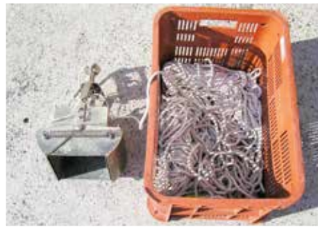
川底のドロをとる器械 (エクマン・バージ型 採泥器)
