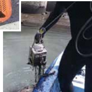
川底のドロをとる器械 (エクマン・バージ型 採泥器)
