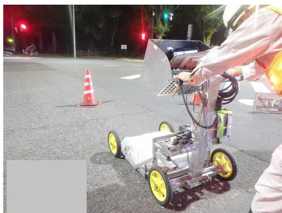
写真-3.5 路面下空洞探査車
