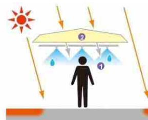
図 微細ミストによる体感温度低下のメカニズム
