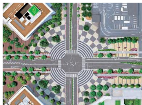
▲市松模様にデザインされた晴海中心軸のインターロッキング舗装 ©晴海五丁目西地区第一種市街地再開発事業特定建築者
