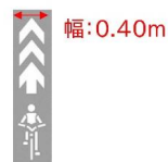
警視庁が設置している ナビマーク
