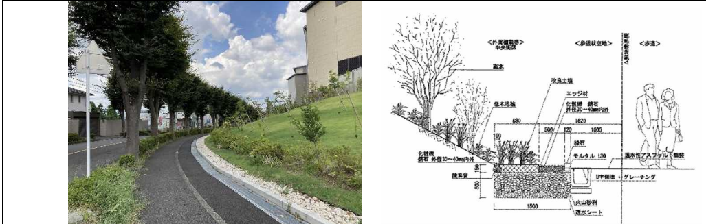
大規模開発事業により設置されたバイオスウェル（南町田グランベリーパーク／町田市） 出典 5
