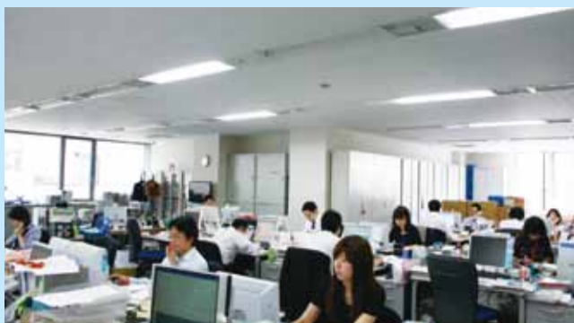
外からの採光を生かし、不要な蛍光灯は間引いて節電
