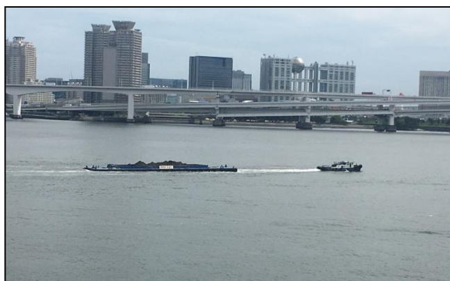
④ 土運船 処分場への曳航状況
