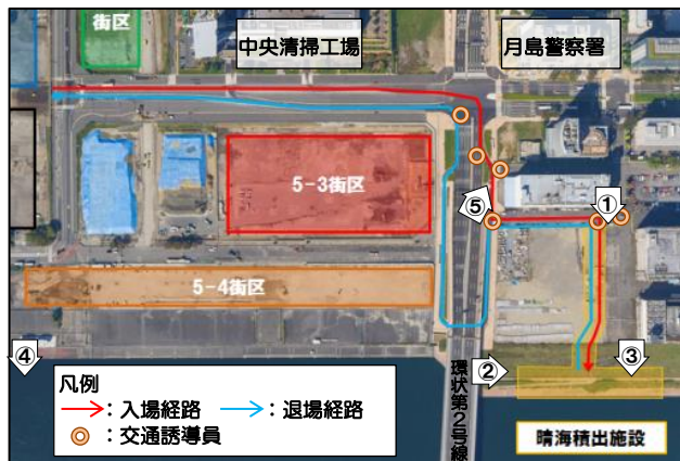
建設発生土の海上輸送 陸上動線図
